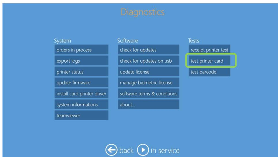
Si une imprimante est installée, connectée et sous tension, le test d'impression de carte démarre. Il est possible de sélectionner l'impression d'un seul côté ou des deux côtés de la carte.
