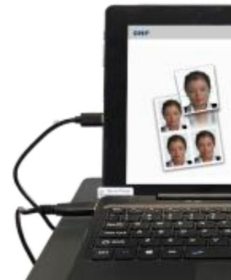
Branchez le câble d'alimentation à une prise électrique. Connectez le câble USB provenant de l'imprimante sur le port USB situé sur le côté gauche du clavier
