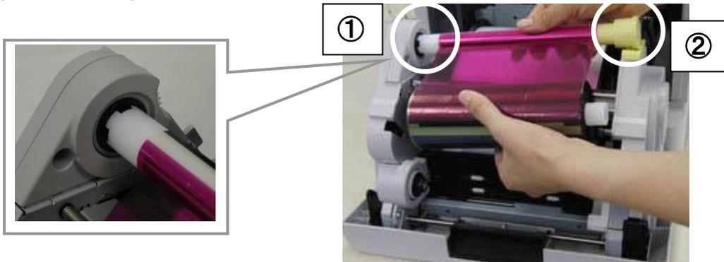
8. Legen die Zufuhrseite des Farbbands vorsichtig in den Drucker ein, um Durchhängen zu vermeiden. Setzen Sie den Vorsprung auf der linken Seite des Kerns in das Loch am Drucker ein und legen Sie dann die rechte Seite in den Halter der gleichen Farbe (weiß) ein. Drehen Sie das Farbband in Richtung der Zufuhrseite, damit das Farbband nicht durchhängt.
